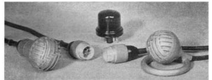
Bild 2. Zwei der neuen Kristall-Mikrophone mit Anschlußsteckern im Vergleich zu einer Stahlröhre.
