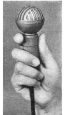
Bild 1. Kleiner als ein Tennisball ist das neue Kristallkugelmikrofon. Es ist bequem in der Hand zu halten, von allen Seiten für die Besprechung gleich empfindlich und sowohl für Musik- wie Sprachübertragung gut geeignet.
